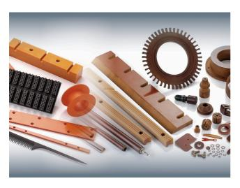
電木板是用酚醛樹酯含浸牛皮紙或者是棉布形成一張一張的膠片半成品後,再經由壓合製成為一大張的電木板成品。所以有紙質與布質電木板的區分。電木板因具有絕緣、不產生靜電、耐磨及耐高溫等特徵,成為電子產品之絕緣開關和可變電阻、機械用之模具及生產線上之治具。此外,也常被用在電器產品的零件上,像是配電盤、機械零件等。
