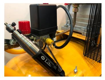
110psi(7.6kg/cm2), 大多數的氣動工具使用的壓力為90psi(6.3kg/cm2)。
