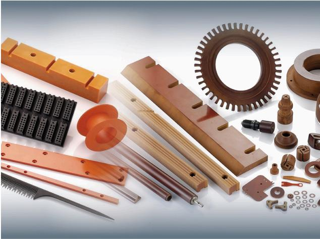
電木板是用酚醛樹脂含浸牛皮紙或者是棉布形成一張一張的膠片半成品後，再經由壓合製成為一大張的電木板成品。所以有紙質與布質電木板的區分。電木板因具有絕緣、不產生靜電、耐磨及耐高溫等特徵，成為電子產品之絕緣開關和可變電阻、機械用之模具及生產線上之治具。此外，也常被用在電器產品的零件上，像是配電盤、機械零件等。
